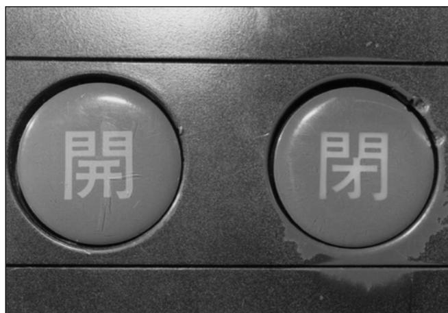
**Unterschied zwischen innen und außen:** Foto zeigt das innere eines japanischen Aufzugs. Der linke Knopf trägt das Schriftzeichen »Öffnen«, der rechte Knopf das Schriftzeichen »Schließen«. Der Schließknopf wird eindeutig öfter betätigt als der linke!
