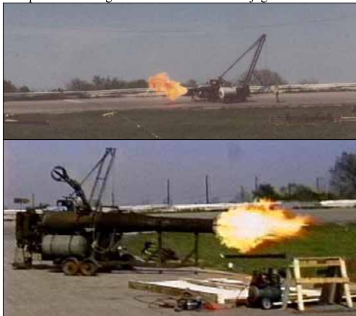
Funktionstüchtiger V1-Raketenmotor, Eigentum der Survival Research Laboratories (SRL), San Francisco
